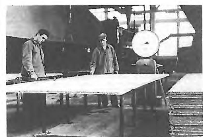
Delavec v Tovarni ivernatih plošč Cerknica merita dimenzije in težo pravkar stisnjene plošče
