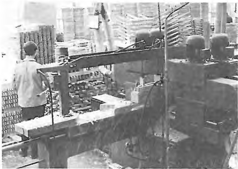
Avtomatični visokoturni kopirni rezkar WIGO v Tovarni pohištva
