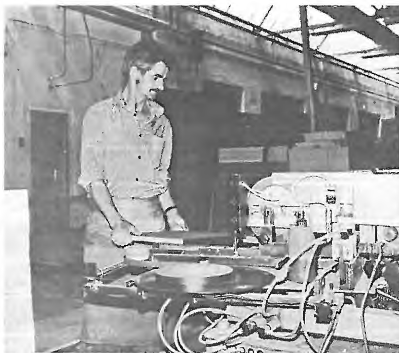
Iz Tovarne pohištva Cerknica — furniranje robov
