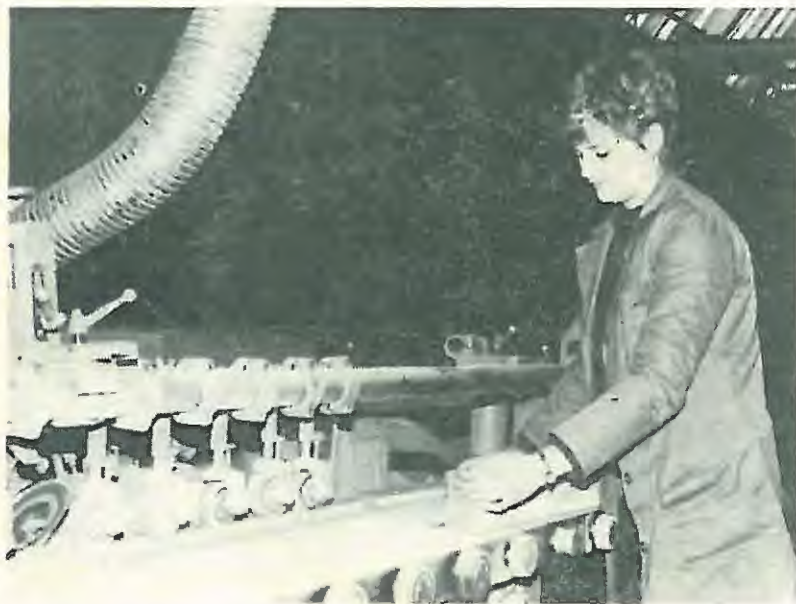
Iz naše proizvodnje — delo pri robovnem brušenju
